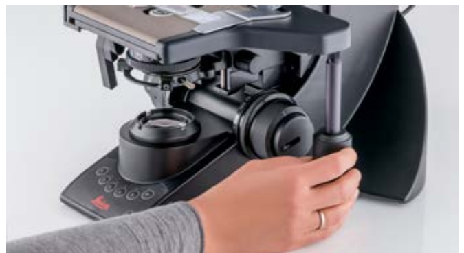
XY载物台位置和聚焦旋钮易于操作，单手即可调节。
